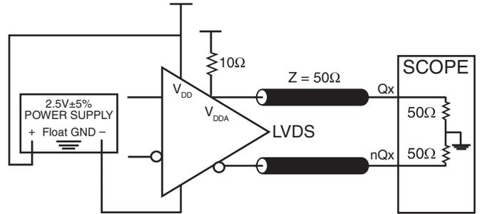
LVDS 2.5V OUTPUT LOAD TEST CIRCUIT
