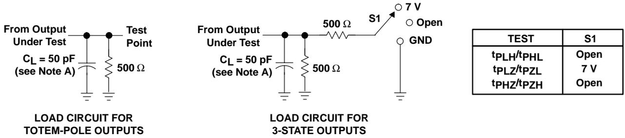
**LOAD CIRCUIT FOR TOTEM-POLE OUTPUTS**
