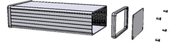
EXTRUSION DESIGNED FOR 100MM WIDE PC BOARD
