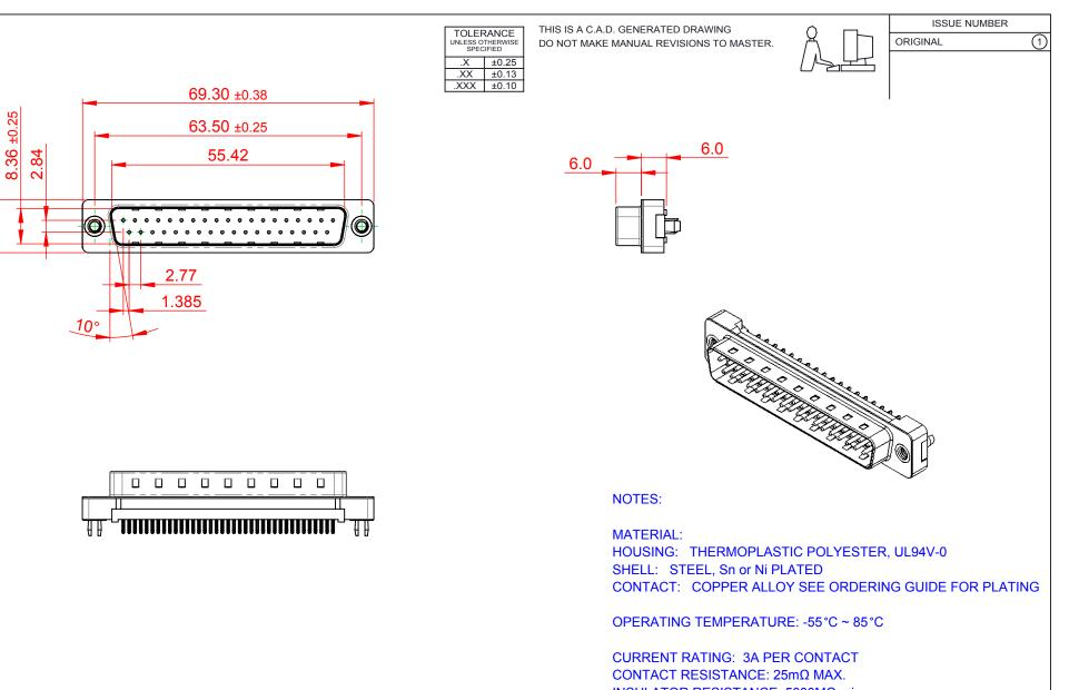
INSULATOR RESISTANCE:  $5000M\Omega$  min. DIELECTRIC
