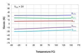
Switch Points  $B_{\mathsf{OPS}}$  and  $B_{\mathsf{RPS}}$  vs Temperature
