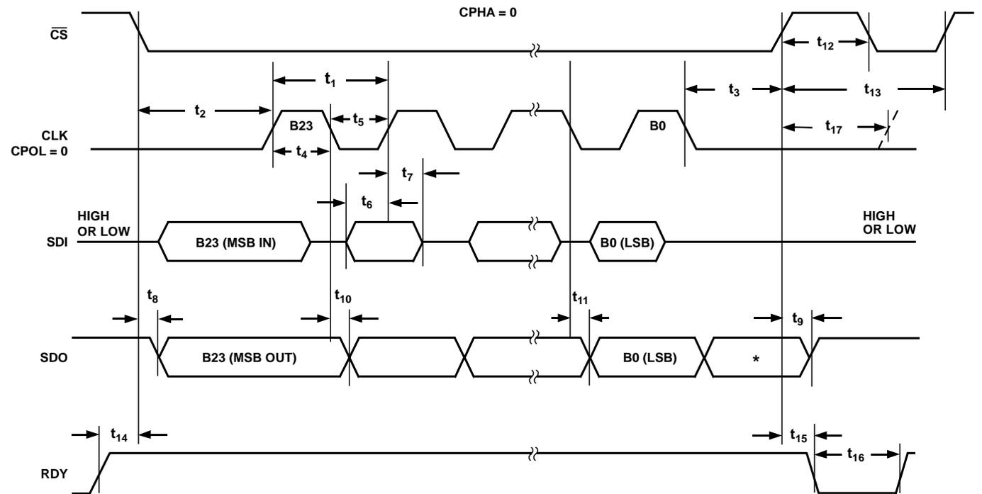
\*THE EXTRA BIT THAT IS NOT DEFINED IS NORMALLY THE MSB OF THE CHARACTER JUST RECEIVED. THE CPOL = 0 MICROCONTROLLER COMMAND ALIGNS THE INCOMING DATA TO THE POSITIVE EDGE OF THE CLOCK.
