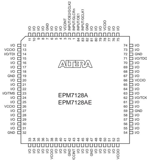
**Figure 17. 100-Pin TQFP Package Pin-Out Diagram**
